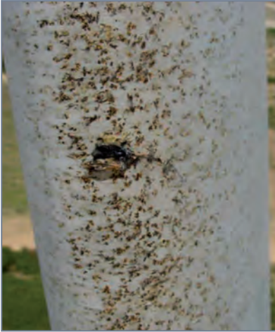
Abb. 28 An Rotorblättern einer Windkraftanlage festgestellte Insektenreste, die bei weiterer Zunahme selbst einen Rückgang der Leistung bewirken können (Aufn.: BladeCleaning 2018 in TRIEB & HAUS 2019)
